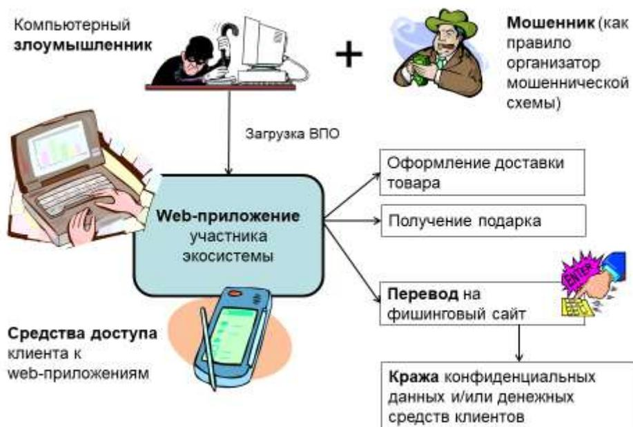
**Рис. 3. / Fig. 3. Обобщенная схема атаки на клиентские web-приложения в условиях функционирования цифровых экосистем / Generalized scheme of attack on client web applications in the conditions of functioning of digital ecosystems**
