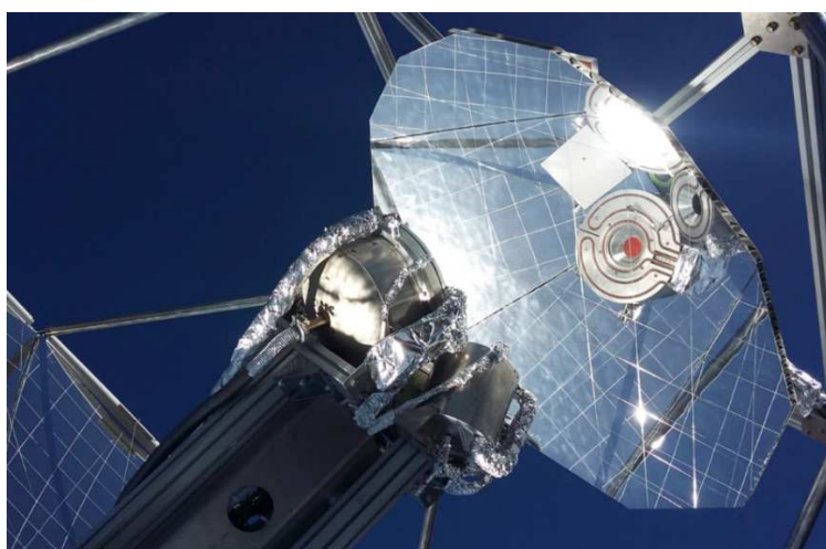
Рис. 3. / Fig. 3. Реактор использует солнечное тепло для преобразования углекислого газа и воды в горючий газ / The reactor uses solar heat to convert carbon dioxide and water into combustible gas
