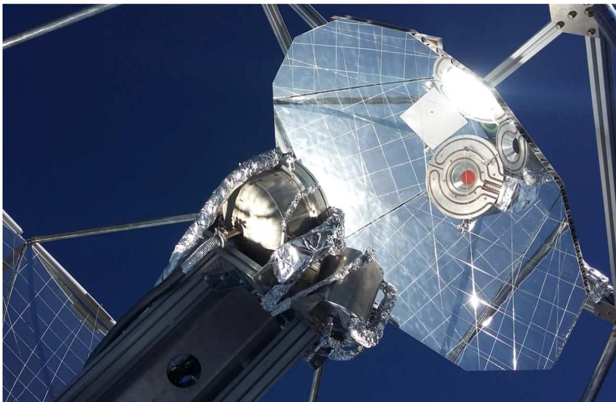
**Рис. 3. / Fig. 1. Реактор использует солнечное тепло для преобразования углекислого газа и воды в горючий газ. Фото ETH, Цюрих / The reactor uses solar heat to convert carbon dioxide and water into combustible gas. Photo by ETH, Zurich**
