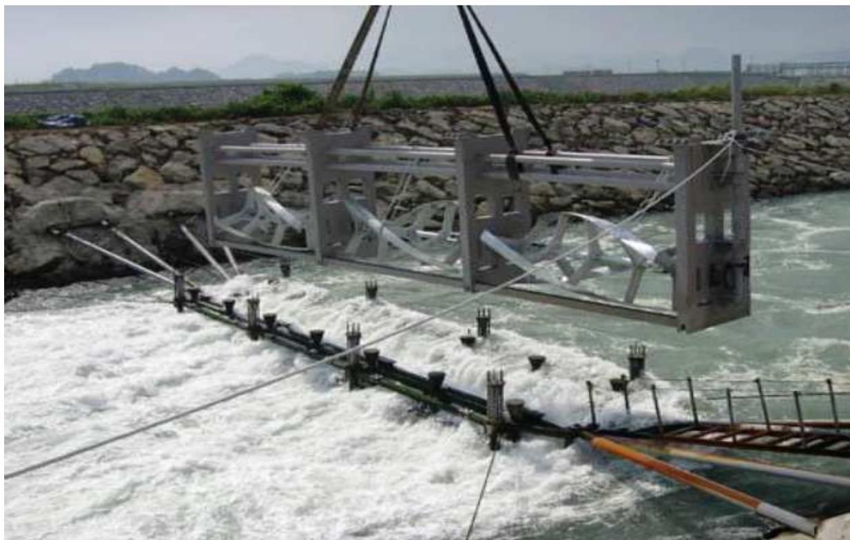
*Рис. 3. / Fig. 3. Один из проектов геликоидного генератора / One of the projects of the helioid generator*
